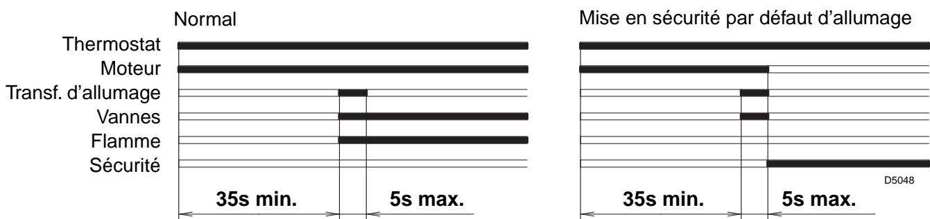
Si la flamme s'éteint durant le fonctionnement, la vanne se ferme en moins d'une seconde. Le brûleur répète le cycle et il y a la mise en sécurité s'il ne s'allume pas.
