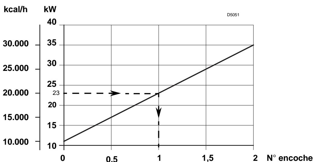
Le diagramme est indicatif et doit être utilisé pour une régulation initiale.
