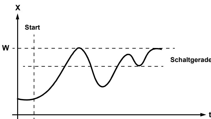
Liegen bei einer Aktivierung **Istwert und Sollwert weit auseinander**, so wird eine Schaltgerade ermittelt, um welche die Regelgröße im Laufe der Selbsteinstellfunktion eine erzwungene Schwingung ausführt. Die Schaltgerade wird so festgelegt, dass der Sollwert möglichst nicht durch den Istwert überschritten wird.
