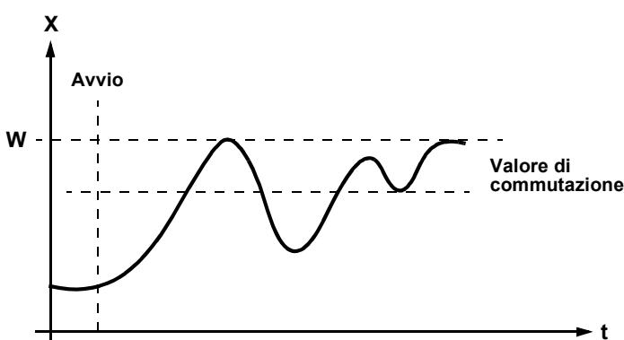
Se sussiste una **grande differenza tra il valore reale e il setpoint** quando si avvia "tunE", la procedura di autoadattamento stabilisce un valore di commutazione intorno al quale il regolatore fa compiere al valore reale una serie di oscillazioni forzate. Il valore di commutazione viene fissato in modo che il valore reale non superi il setpoint.
