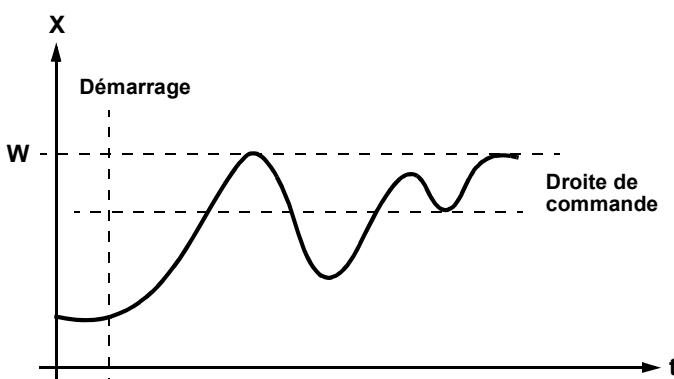
Si, au moment de l'activation, la **valeur instantanée et la valeur de consigne sont très éloignées** l'une de l'autre, la fonction détermine une droite de commande autour de laquelle la grandeur réglée effectue une oscillation forcée au cours de la fonction d'auto-réglage "tunE". La droite de commande est déterminée de façon à éviter si possible que la consigne ne soit dépassée par la valeur instantanée.
